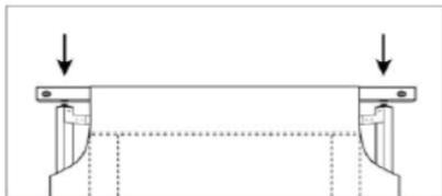
3. Zweites Querrohr an einer Seite des Längsrohres aufsetzen und das andere Ende kräftig ziehend auf das Längsrohr heben.
