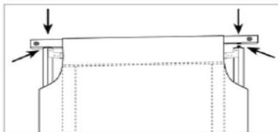
Bei größeren Spannproblemen den Bezug wechselweise strecken. Dazu das Querrohr abwechselnd links oder rechts zum Ziehen ansetzen.
