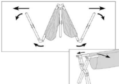
2. Erstes Querrohr durch den Bezug schieben und bei den kleineren Bohrungen auf die beiden Längsrohre aufsetzen.
